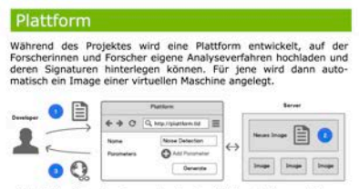
Abb 2: Use-Case: Benutzung einer Analyse-VM. ForscherInnen wählen die passende Software in der Plattform aus (1) und öffnen eigene Biosignaldaten im Browser (2), womit das Analyseprogramm in der lokalen VM ausgeführt wird (3). Anschließend werden die Ergebnisse dargestellt (4).
